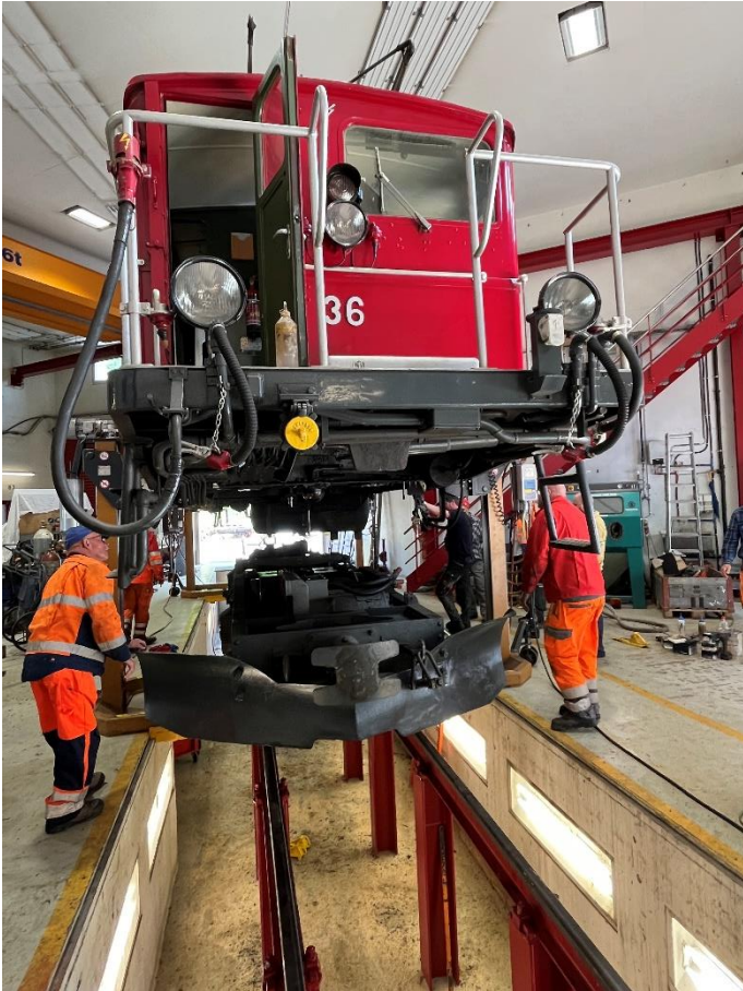
Andere Schneeräumer unterstützen die Kollegen der MGB Historic beim Einachsen der HGe 36 im Depot Realp.
