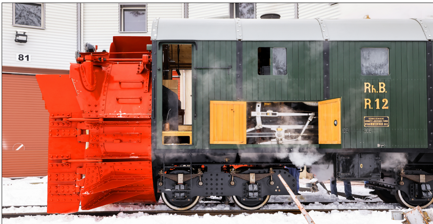
Seitenaufnahme mit dem geöffneten Dampftrieb des Rotary-Schleuderrades (Foto: Georg Trüb)
