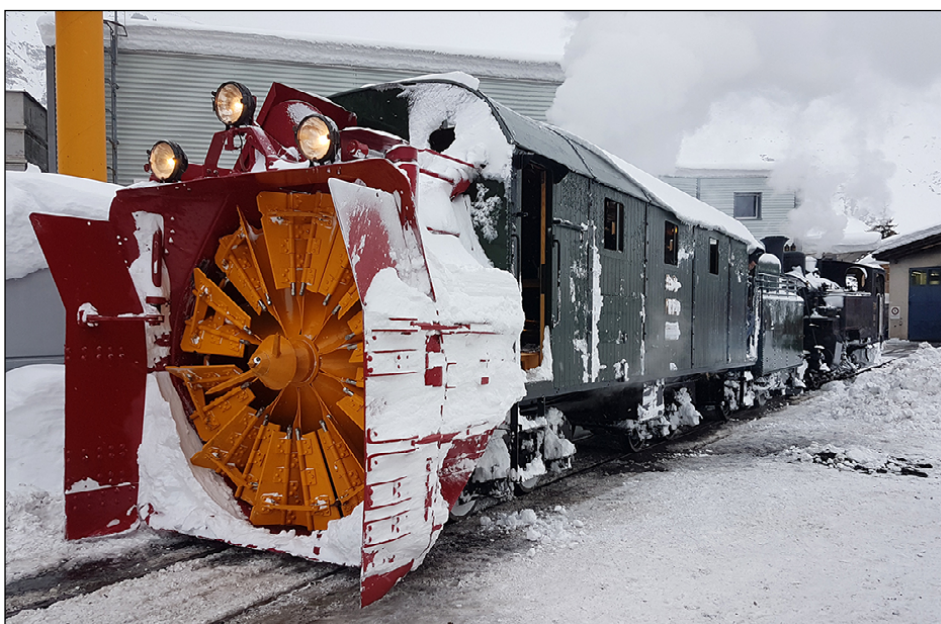
Schleuder-Komposition nach dem Räumeeinsatz (Foto: Martin Horath).
