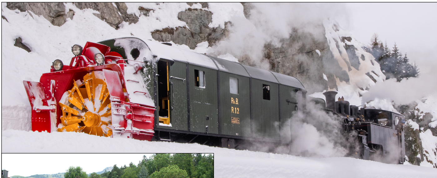
Die nicht selbstfahrende Schneeschleuder R12 wird jeweils von einer Dampf- oder Diesellokomotive befördert (Foto: Georg Trüb).
