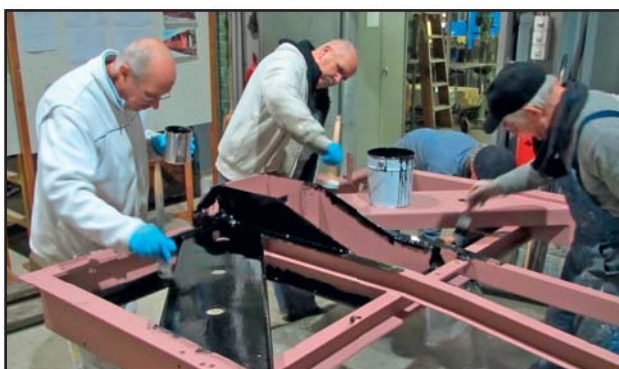
Schutzanstrich eines Chassisrahmens nach dem Sandstrahlen und Grundieren
