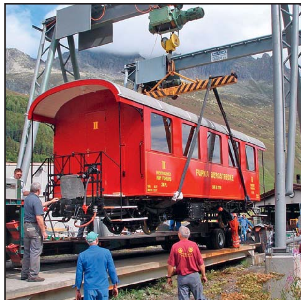
Zurück am Berg werden die Wagen mit dem Portalcrane auf die „heimischen“ Gleise gesetzt
