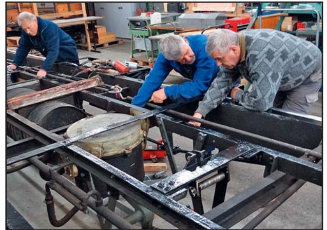
Der Vakuumzylinder erzeugt die Bremskraft
