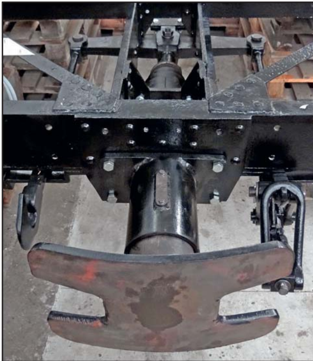
Die Schraubenkupplung und der Haken der Zugvorrichtung sind hinter dem Puffer über eine Waage federnd mit dem Chassis verbunden
