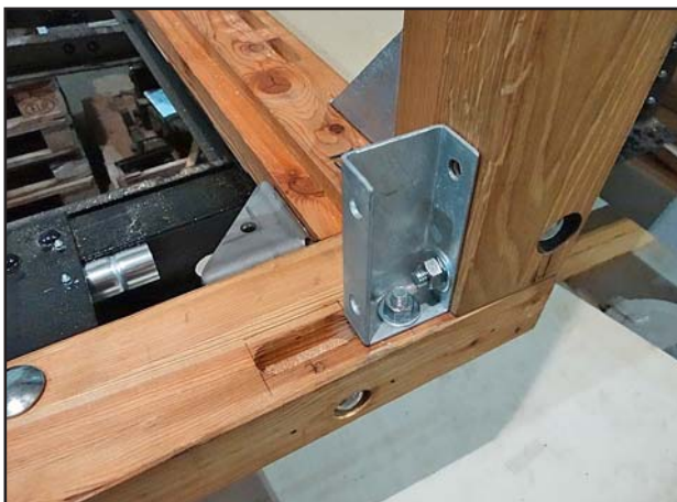
Zapfen, Nuten und Verschraubungen geben dem Wagenkasten seine Stabilität
