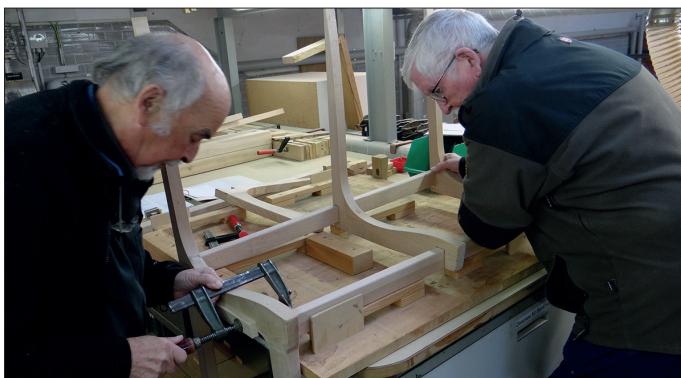
Bau der Inneneinrichtung des Personenwagens AB 4463 Fotos: Heinz Unterweger und Archiv Wagenwerkstatt Aarau
