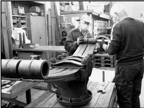
*Auch die Zahnradachse und die Federpakete werden zerlegt, überarbeitet und wieder zusammgebaut*
