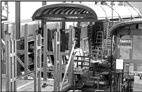
Am 18. August schauften wir vier Hebegurte um die Querbalken, die wir an berechneten Stellen unter den Dachpfetten positioniert hatten und hoben das Dach sanft an. Dabei wurde der gleichmässigen Gewichtsverteilung hohe Beachtung zuteil, um das fragile Dach nicht zu überbeanspruchen. Die Aktion war ursprünglich für den 18. März geplant und die Sitzplatzsponsoren bereits dazu eingeladen. Wegen Corona mussten wir kurzfristig abblasen.
